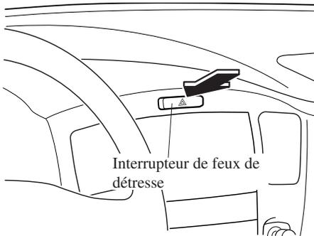
Appuyer sur l'interrupteur de feux de détresse et les quatre clignotants clignotent simultanément.
