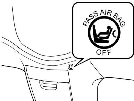
Si les capteurs de poids du siège du passager avant sont normaux, le témoin s'allume lorsque le contacteur d'allumage est mis à la position ON. Il s'éteint après 6 secondes environ.
