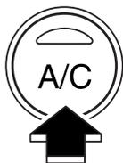
Appuyer sur cet interrupteur pour mettre le climatiseur sous tension. Un témoin s'allume sur l'interrupteur lorsque le cadran de commande du ventilateur est sur la position 1, 2, 3 ou 4.
