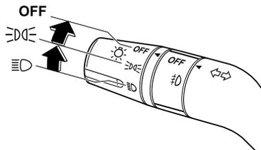
Tourner la commande des phares pour allumer et éteindre les phares, autres éclairages extérieurs et éclairage du tableau de bord.
