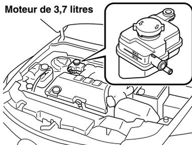
Le niveau doit se trouver entre les repères MAX et MIN.
