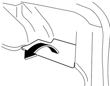
3. Tourner le boulon à oreilles et la vis du cric dans le sens contraire des aiguilles d'une montre.
