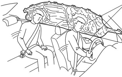
Les coussins d'air latéraux et rideaux de sécurité gonflables ne se déploient que du côté du véhicule qui reçoit l'impact.
