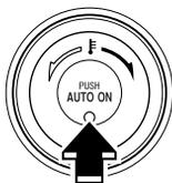
2. Utiliser le cadran de commande de température pour sélectionner la température désirée. Appuyer sur la touche DUAL ou tourner le cadran de commande de la température du passager avant pour contrôler la température réglée individuellement pour le conducteur et le passager avant.
