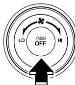
Appuyer sur la touche OFF pour éteindre le système de commande de température.
