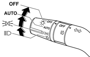
Tourner la commande des phares pour allumer et éteindre les phares, autres éclairages extérieurs et éclairage du tableau de bord.
