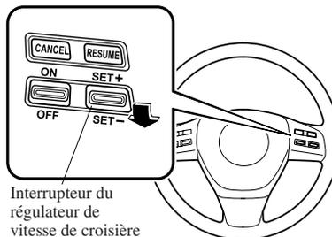
Ce véhicule est équipé d'une fonction qui permet de réduire la vitesse actuelle du véhicule de 1,6 km/h (1 mi/h) par une pression momentanée de l'interrupteur SET - de régulateur de vitesse de croisière. Plusieurs pressions réduiront la vitesse du véhicule de 1,6 km/h (1 mi/h) pour chaque pression.
