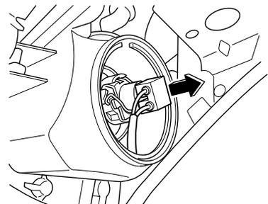
6. Décrocher le ressort de retenue de l'ampoule.
