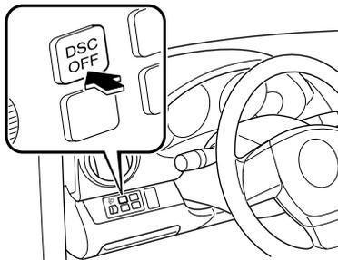
Appuyer sur l'interrupteur DSC OFF de nouveau pour remettre le système de commande de traction/système de commande dynamique de stabilité en fonction. Le témoin DSC OFF s'éteindra.
