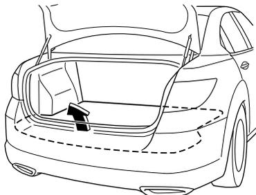
2. Tourner le boulon de fixation de la roue de secours dans le sens contraire des aiguilles d'une montre, à l'aide de la clé à écrou de roue.
