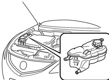
Si le niveau se trouve au niveau ou à proximité du repère LOW ou L, ajouter suffisamment de liquide de refroidissement spécifié dans le réservoir de liquide de refroidissement pour la protection contre le gel et la corrosion et porter le niveau jusqu'au repère FULL ou F.
