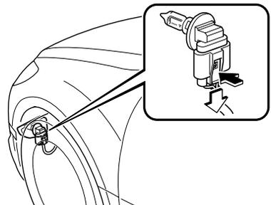
4. Tourner l'ensemble douille et ampoule et le retirer. Retirer prudemment l'ampoule de la douille du réflecteur en la tirant doucement en un mouvement rectiligne.
