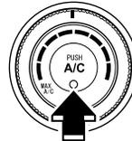
Appuyer sur l'interrupteur A/C pour mettre le climatiseur sous tension. Le témoin s'allume sur l'interrupteur lorsque le cadran de commande du ventilateur est sur la position 1, 2, 3 ou 4.
