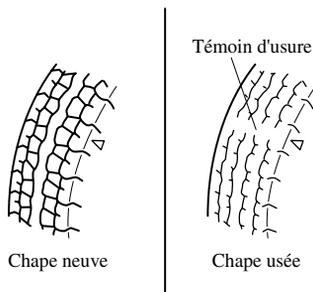
Le remplacement d'un pneu usé irrégulièrement est nécessaire avant que le témoin d'usure n'apparaisse en travers de la chape.
