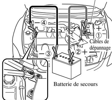
1. S'assurer que la batterie de secours est de 12 V et que la borne négative est mise à la masse.
