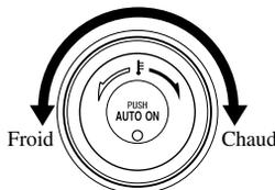
Ce cadran commande la température. Le tourner dans le sens des aiguilles d'une montre pour de l'air plus chaud et dans le sens contraire pour de l'air plus froid.
