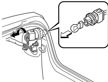
4. Installer la nouvelle ampoule dans l'ordre inverse du retrait.
