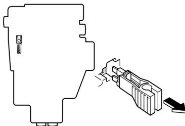
4. Vérifier le fusible et le remplacer s'il est fondu.
