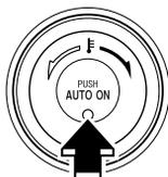
En appuyant sur la touche AUTO, les fonctions suivantes sont automatiquement commandées suivant la température réglée:
