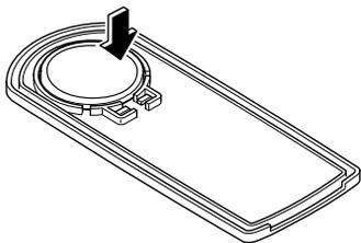
4. Installer une nouvelle pile (CR2025 ou équivalente) en orientant la borne positive vers le bas.
