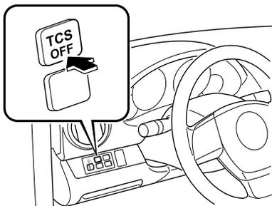
Appuyer sur l'interrupteur TCS OFF de nouveau pour remettre le système de commande de traction en fonction. Le témoin TCS OFF s'éteint.
