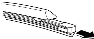
5. Retirer les barres métalliques du caoutchouc de chaque balai d'essuie-glace et les monter sur un caoutchouc de balai d'essuie-glace neuf.
