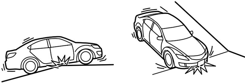
Le véhicule est équipé de pneus surbaissés qui assurent des performances et une manœuvrabilité de qualité. En conséquence, la paroi des pneus est très fine et les pneus et les roues peuvent être endommagés lors de la conduite sur des nids-de-poule ou des routes accidentées/irrégulières à grande vitesse. Faire preuve de prudence et réduire la vitesse lors de la conduite sur des routes accidentées/irrégulières ou sur des nids-de-poule.
