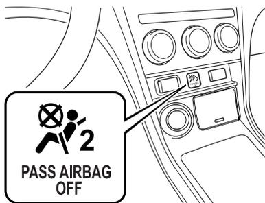
Si les capteurs de poids du siège du passager avant sont normaux, le témoin s'allume lorsque le contacteur d'allumage est mis à la position ON. Il s'éteint après un laps de temps spécifié.
