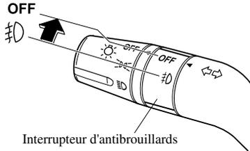
Pour les éteindre, tourner l'interrupteur d'antibrouillards à la position OFF ou mettre la commande des phares sur la position
