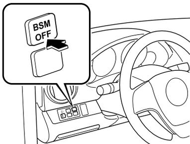
Appuyer de nouveau sur l'interrupteur BSM OFF pour activer le système BSM. Le témoin BSM OFF s'éteint.
