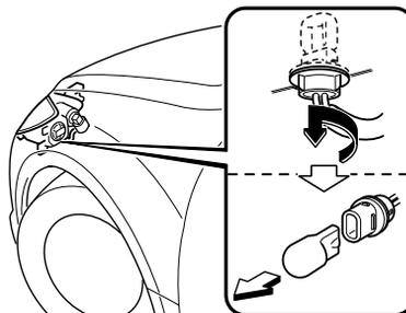
6. Installer la nouvelle ampoule dans l'ordre inverse du retrait.
