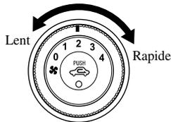
Ce cadran permet de régler la vitesse du ventilateur.
