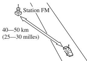
Les signaux provenant d'un émetteur FM peuvent être comparés à des faisceaux lumineux: ils ne s'incurvent jamais, mais peuvent par contre être réfléchis. Contrairement aux signaux AM, les signaux FM ne peuvent aller plus loin que l'horizon. Par conséquent la portée des stations FM n'atteint pas celle des stations AM.
