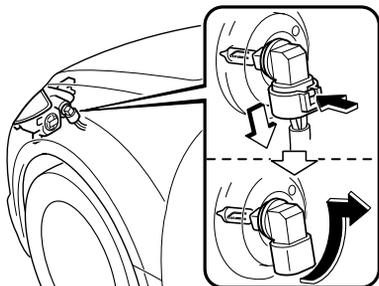
5. Installer la nouvelle ampoule dans l'ordre inverse du retrait.
