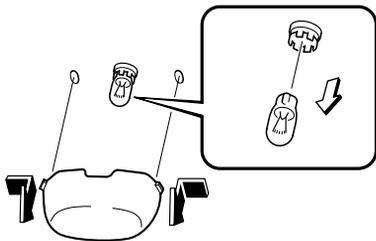
3. Installer la nouvelle ampoule dans l'ordre inverse du retrait.
