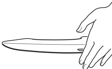
Les emplacements suivants sont verrouillés en touchant la zone de détection du capteur tactile de verrouillage de porte.
