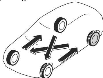
Ne pas inclure la roue de secours (USAGE TEMPORAIRE UNIQUEMENT) dans la permutation.
