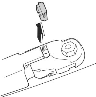
3. Relever le bras d'essuie-glace et tourner le balai d'essuie-glace vers la droite jusqu'à ce qu'il se déverrouille, puis retirer le balai.
