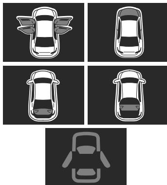
L'éclairage s'allume s'il y a une portière/couvercle du coffre/hayon/capot qui n'est pas bien fermé(e). En outre, l'avertissement sonore retentit si une portière/le hayon/couvercle du coffre n'est pas fermé(e) et que le véhicule roule.
