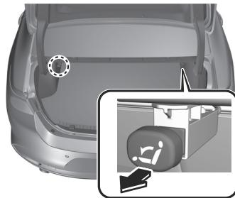
3. Ouvrir une portière arrière et replier le siège arrière vers l'avant.
