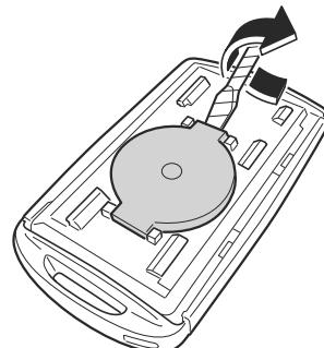
6. Retirer la batterie à l'aide d'un tournevis à tête plate entouré de bande adhésive.
