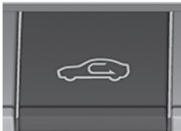
Chaque fois que l'interrupteur est enfoncé, le mode bascule entre le mode de recirculation et le mode d'air frais.
