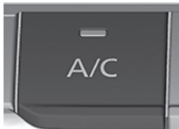
La fonction de refroidissement/déshumidification est activée/désactivée chaque fois que l'interrupteur est enfoncé. Le témoin s'allume lorsque la fonction est en marche.
