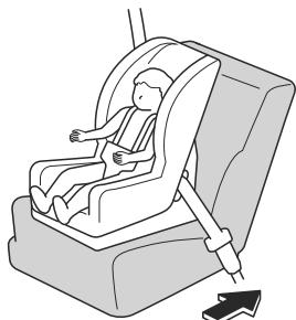
**Dans certaines conditions, il est dangereux de faire asseoir un enfant dans un système de dispositif de sécurité pour enfants installé sur le siège du passager avant (avec système de classification de l'occupant du siège du passager avant).**
