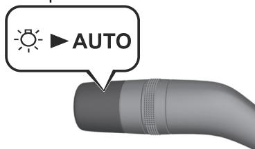
Les feux de position diurnes s'allument automatiquement lorsqu'il fait clair, et les phares, les feux de stationnement, les feux arrière, les feux de position latéraux et les feux de plaque d'immatriculation s'allument automatiquement lorsqu'il fait sombre.
