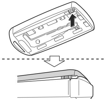
3. Insérer un tournevis à tête plate enroulé de ruban dans l'espace et le glisser.
