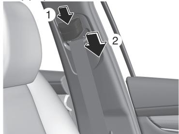
2. S'assurer que le dispositif de réglage de l'ancrage de la ceinture de sécurité est bien verrouillé.
