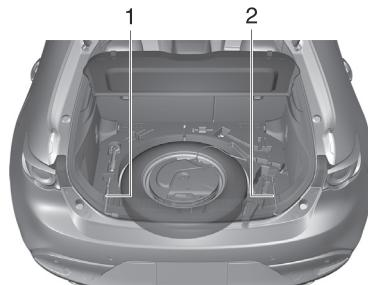
1. Clé à écrou de roue
