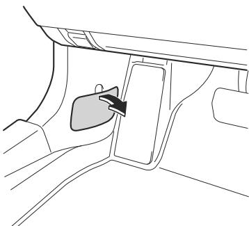
3. Tirer le fusible droit à l'aide de l'outil de retrait fourni dans la boîte à fusibles du compartiment moteur.
