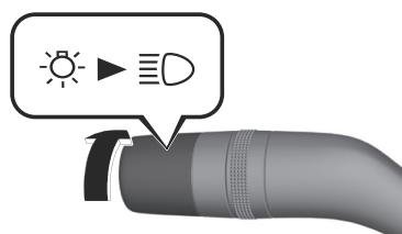
Les phares, les feux de stationnement, les feux arrière, les feux de position latéraux et les feux de plaque d'immatriculation s'allument, et le témoin des feux de stationnement s'allume sur le combiné d'instruments.
