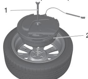
1. Boulon de fixation de pneu à plat
