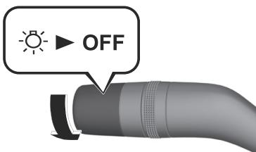
L'interrupteur d'éclairage revient automatiquement à la position **AUTO**.
