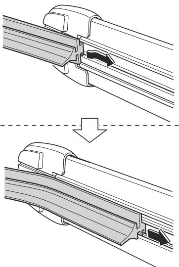
8. S'assurer que le balai en caoutchouc est correctement installé dans le support de balai.
