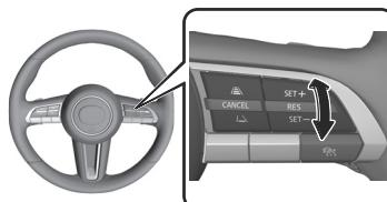
La conduite à vitesse constante commence lorsque la vitesse du véhicule est réglée. De plus, la vitesse de consigne est affichée à l'écran, et l'indication de veille MRCC (blanche) devient l'indication de réglage MRCC (verte) .
