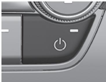
Permet d'activer et de désactiver le système de climatisation. Le témoin s'allume lorsque la fonction est en marche.
