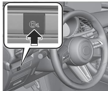
Lorsque l'interrupteur de sourdine i-ACTIVSENSE est enfoncé pendant que les systèmes suivants fonctionnent, l'avertissement sonore est désactivé.
