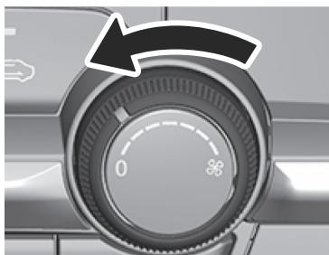
Ce cadran permet de régler la vitesse du ventilateur.
