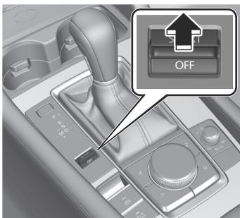
Lors de la sélection du mode sport, le témoin du mode de conduite sélectionné **SPORT** s'allume sur le combiné d'instruments.
