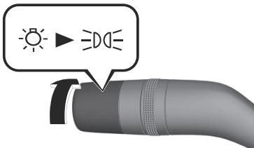
Les feux de stationnement, les feux arrière, les feux de position latéraux et les feux de plaque d'immatriculation s'allument, et le témoin des feux de stationnement s'allume sur le combiné d'instruments.
