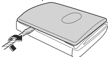
5. Retirer le capuchon à l'aide d'un tournevis à tête plate enveloppé de ruban adhésif.
