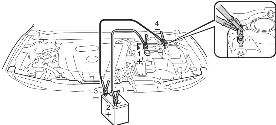
4. Démarrer le moteur du véhicule de secours et faire tourner le moteur.
