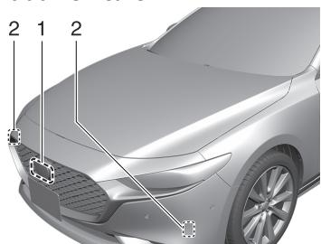
1. Capteur radar avant\*
