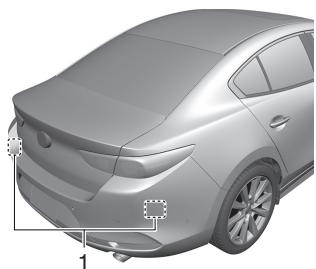
1. Capteurs radar latéraux arrière\*
