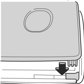
10. Fixer le couvercle inférieur de sorte que ses languettes soient insérées dans les fentes de la clé.
