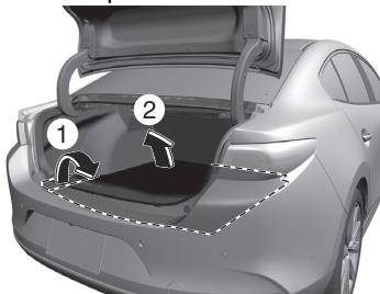
2. Tourner le boulon de fixation de roue de secours dans le sens inverse des aiguilles d'une montre et retirer la roue de secours.
