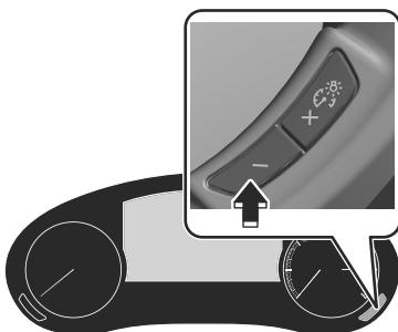
Si vous appuyez à nouveau sur le contacteur - alors que la luminosité du tableau de bord est au maximum, un son retentit pour vous signaler que le réglage est au maximum.
