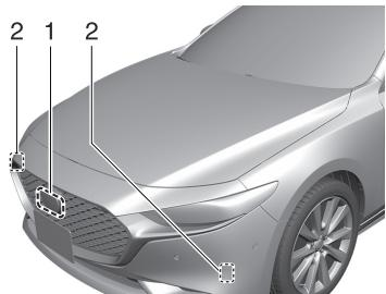
1. Capteur radar avant\*
