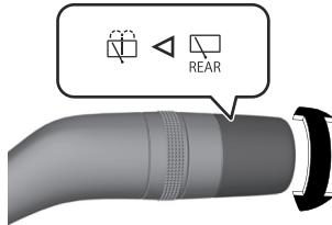
Lorsque l'interrupteur est en position , le liquide de lave-glace est pulvérisé et l'essuie-glace fonctionne.
