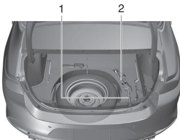
1. Clé à écrou de roue
