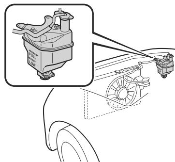
S'il est à la position LOW (bas) ou proche de celle-ci, ajouter suffisamment de liquide de refroidissement dans le réservoir pour assurer une protection contre le gel et la corrosion et pour porter le niveau à FULL (plein).
