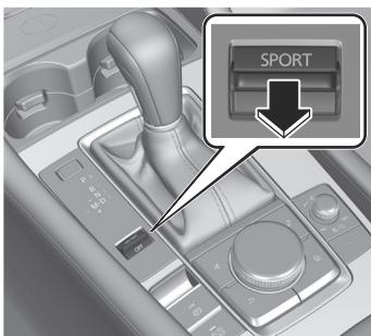
Lorsque le mode SPORT est annulé, le témoin de mode de conduite sélectionné **SPORT** s'éteint dans le combiné d'instruments.
