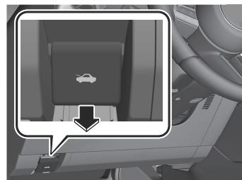
2. Passer la main dans l'ouverture du capot, faire glisser le loquet dans le sens de la flèche indiquée sur l'illustration, puis soulever le capot.
