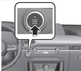
Le moteur s'arrête et l'alimentation du véhicule est positionnée sur OFF.
