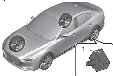
1. Capteur de pression des pneus
