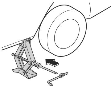
8. Tourner la manivelle du cric dans le sens des aiguilles d'une montre pour soulever le véhicule juste assez pour que la roue de secours puisse être installée. Avant de retirer les écrous de roue s'assurer que le véhicule est bien stable et ne risque pas de glisser ou de se déplacer.
