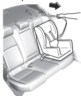
6. Placer le système de dispositif de sécurité pour enfant fermement sur le siège du véhicule. S'assurer que la ceinture se rétracte et serre le système de dispositif de sécurité pour enfants. Pendant que la courroie est enroulée, un déclic se fera entendre sur l'enrouleur lorsqu'il est en mode de blocage automatique. Si la ceinture ne bloque pas le système de dispositif de sécurité pour enfants fermement, répéter cette étape.
