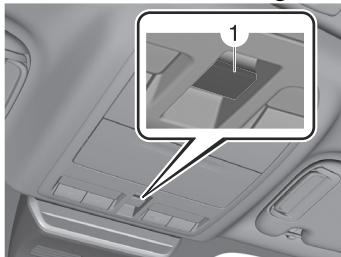
1. Interrupteur d'inclinaison/de coulissemement
