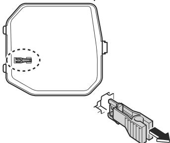
4. Vérifier le fusible et le remplacer s'il est fondu.
