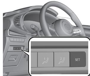
4. Effectuer l'opération suivante dans les 5 secondes suivant l'activation du son pour programmer la position de conduite.
