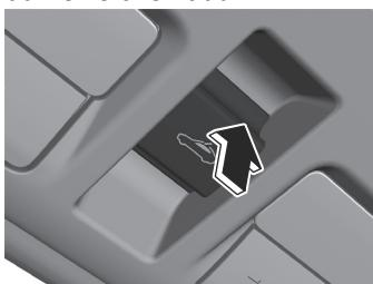
3. Appuyer sur l'interrupteur d'inclinaison/de coulissemement vers l'avant.
