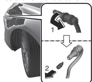
7. Débrancher l'ampoule de la douille.
