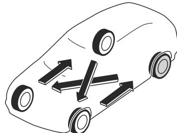
Ne pas inclure la roue de secours (USAGE TEMPORAIRE UNIQUEMENT) dans la permutation.
