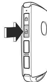
Lorsque le véhicule reçoit un signal de fonctionnement de la clé, les phares, les feux de stationnement, les feux arrière, les feux de position avant et les feux de plaque d'immatriculation s'allument.
