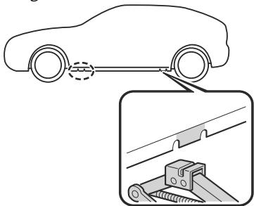
6. Continuer à soulever progressivement la tête du cric en faisant tourner la vis avec votre main jusqu'à ce que la tête du cric soit insérée dans la position de levage.
