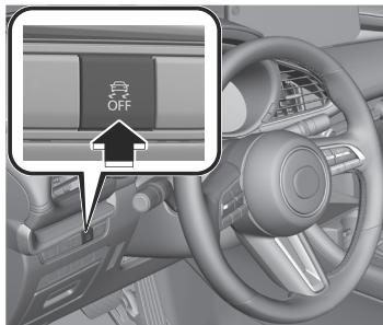
Le fonctionnement du système TCS/DSC est annulé et le témoin DSC OFF
