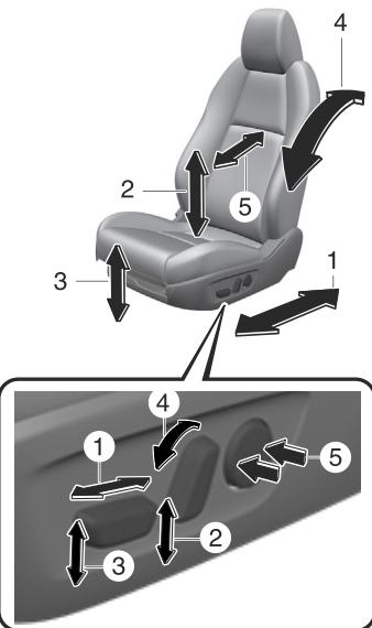
1. Réglage longitudinal du siège
