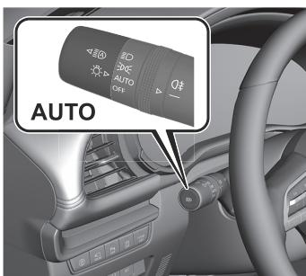
Le système HBC détermine les conditions environnantes et fonctionne automatiquement.
