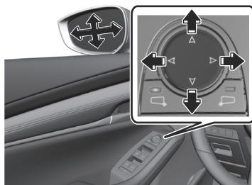
4. Appuyer sur le bouton de sélection situé sur le côté du rétroviseur extérieur qui a été réglé.
