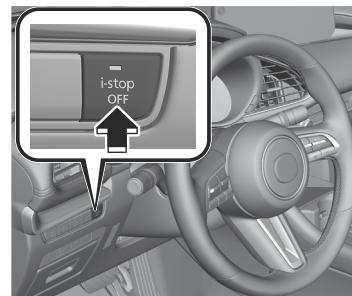
La fonction i-stop s'arrête et le témoin de l'interrupteur i-stop OFF s'allume.
