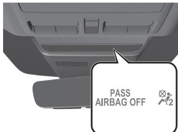
Si les capteurs de poids du siège du passager avant fonctionnent normalement, le témoin s'allume lorsque l'alimentation du véhicule est mise sur ON. L'éclairage s'éteindra après quelques secondes. Puis le témoin s'illumine ou s'éteint dans les conditions suivantes :
