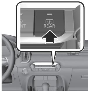
Le désembuage de la lunette arrière fonctionne et le témoin de l'interrupteur s'allume.
