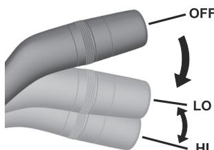
En position LO, les essuie-glaces de pare-brise fonctionnent à faible vitesse. En position HI, les essuie-glaces fonctionnent à grande vitesse.
