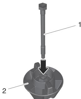
1. Boulon de fixation de la roue crevée
