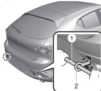
1. Clé à écrou de roue
