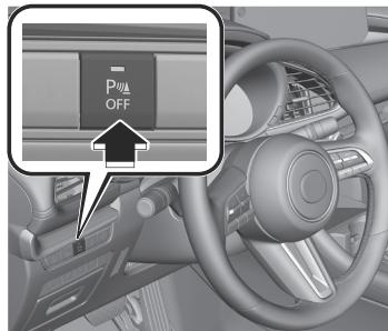
Les capteurs de stationnement s'éteignent et le témoin de l'interrupteur de désactivation des capteurs de stationnement s'allume.
