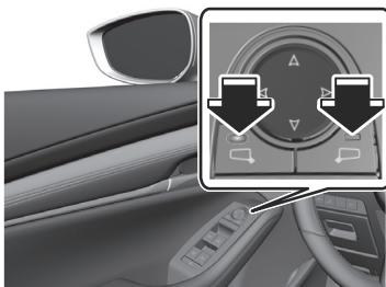
3. Appuyer sur l'interrupteur de réglage pour régler l'angle du rétroviseur extérieur.
