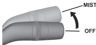
Les essuie-glaces de pare-brise fonctionnent lorsque le levier est en position MIST.
