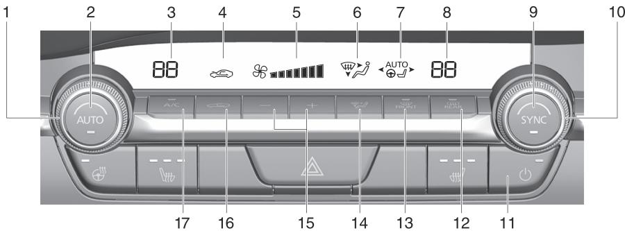
1. Cadran de commande de température du conducteur
