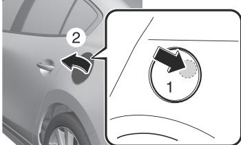
5. Tourner lentement le bouchon du réservoir de carburant.
