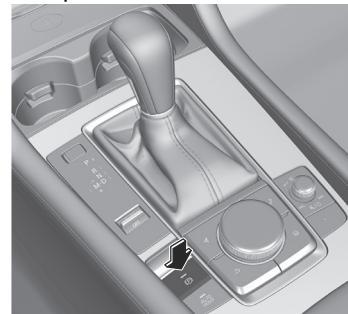
Après l'annulation du fonctionnement automatique du frein de stationnement, un son d'avertissement retentit une fois, et le témoin de l'interrupteur EPB passe de l'éclairage au clignotement, puis s'éteint au bout d'un certain temps.
