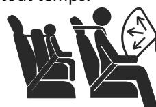
**Ne pas installer un système de dispositif de sécurité pour enfants faisant face à l'avant du véhicule sur le siège du passager avant, sauf si c'est absolument inévitable.**
