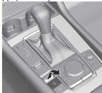
Le frein de stationnement est serré et le témoin de l'EPB
