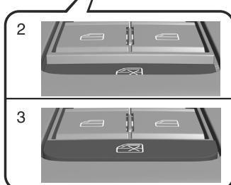
1. Interrupteur de verrouillage de lève-vitres électriques
