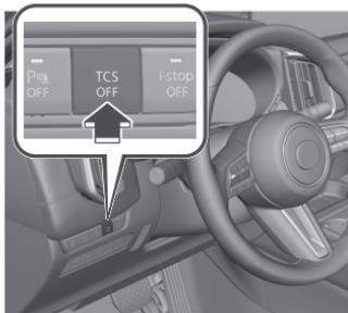
Le fonctionnement du système TCS est annulé et le témoin TCS OFF
