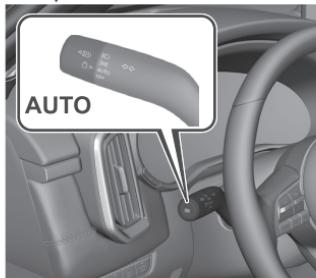
Le système HBC détermine les conditions environnantes et fonctionne automatiquement.
