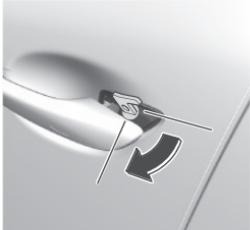
5. Remettre la clé auxiliaire dans sa position initiale.
