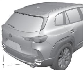
1. Capteurs radar latéraux arrière
