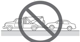
➤ Si le frein de stationnement ne peut pas être desserré lors du remorquage du véhicule, transporter le véhicule avec les roues avant et arrière soulevées du sol, comme le montre l'illustration. Remorquer le véhicule sans soulever les roues du sol peut endommager le système de freinage.
