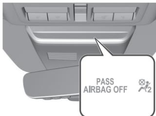
Si les capteurs de poids du siège du passager avant fonctionnent normalement, le témoin s'allume lorsque l'alimentation du véhicule est mise sur ON. L'éclairage s'éteindra après quelques secondes. Puis le témoin s'illuminera ou s'éteindra dans les conditions suivantes :
