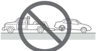
➤ Ne pas utiliser un équipement de remorquage de type à câble. Cela risque d'endommager le véhicule. Utiliser un système à prise sous roues ou un camion à plate-forme.
