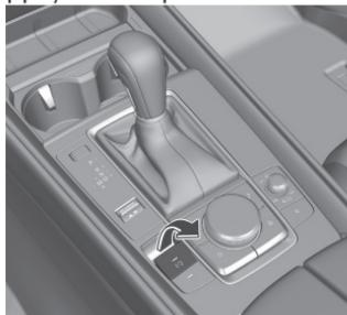
Le frein de stationnement est serré et le témoin de l'EPB sur le combiné d'instruments et le témoin de l'interrupteur de l'EPB s'allument.
