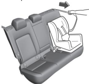
6. Placer le système de dispositif de sécurité pour enfants fermement sur le siège du véhicule. S'assurer que la ceinture se rétracte et serre le système de dispositif de sécurité pour enfants. Pendant que la courroie est enroulée, un déclic se fera entendre sur l'enrouleur lorsqu'il est en mode de blocage automatique. Si la ceinture ne bloque pas le système de dispositif
