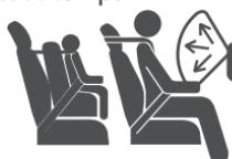
**Ne pas installer un système de dispositif de sécurité pour enfants faisant face à l'avant du véhicule sur le siège du passager avant, sauf si c'est absolument inévitable.**
