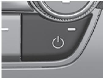
Permet d'activer et de désactiver le système de climatisation.
