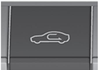
Chaque fois que l'interrupteur est enfoncé, le mode bascule entre le mode de recirculation et le mode d'air frais.
