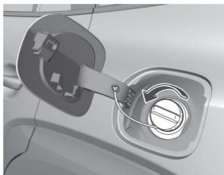
6. Placer le bouchon du réservoir de carburant sur le support de la trappe de remplissage de carburant.
