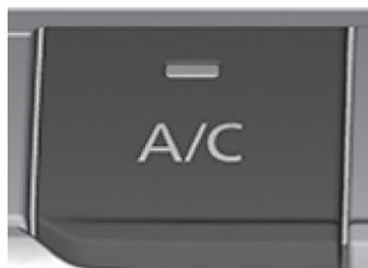
La fonction de refroidissement/deshumidification est activée/désactivée chaque fois que l'interrupteur est enfoncé. Le témoin s'allume lorsque la fonction est en marche.
